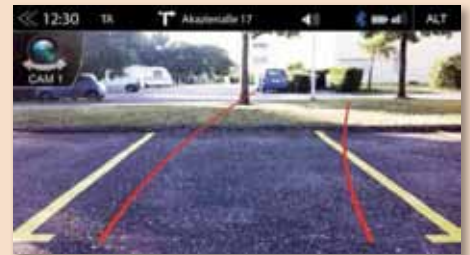
Rückfahrkamera mit dynamischen Hilfslinien
