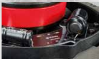
Frequenzweiche an der Korbrückseite
